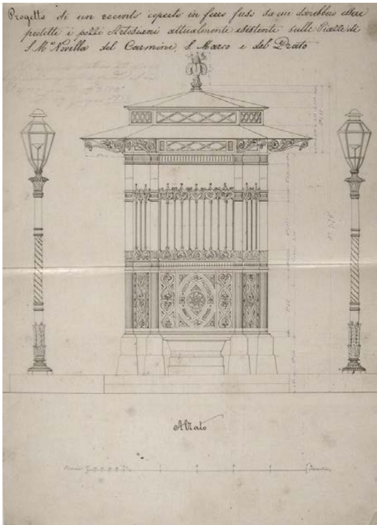
Modello del 1865 del direttore dell'Ufficio d'arte di un recinto in ferro per coprire i pozzi artesiani nelle piazze del Carmine, S. Maria Novella, S. Marco e al Prato ( ASCFi, Sindaco, Ufficio d'arte, 228, aff. 671 or. ).
