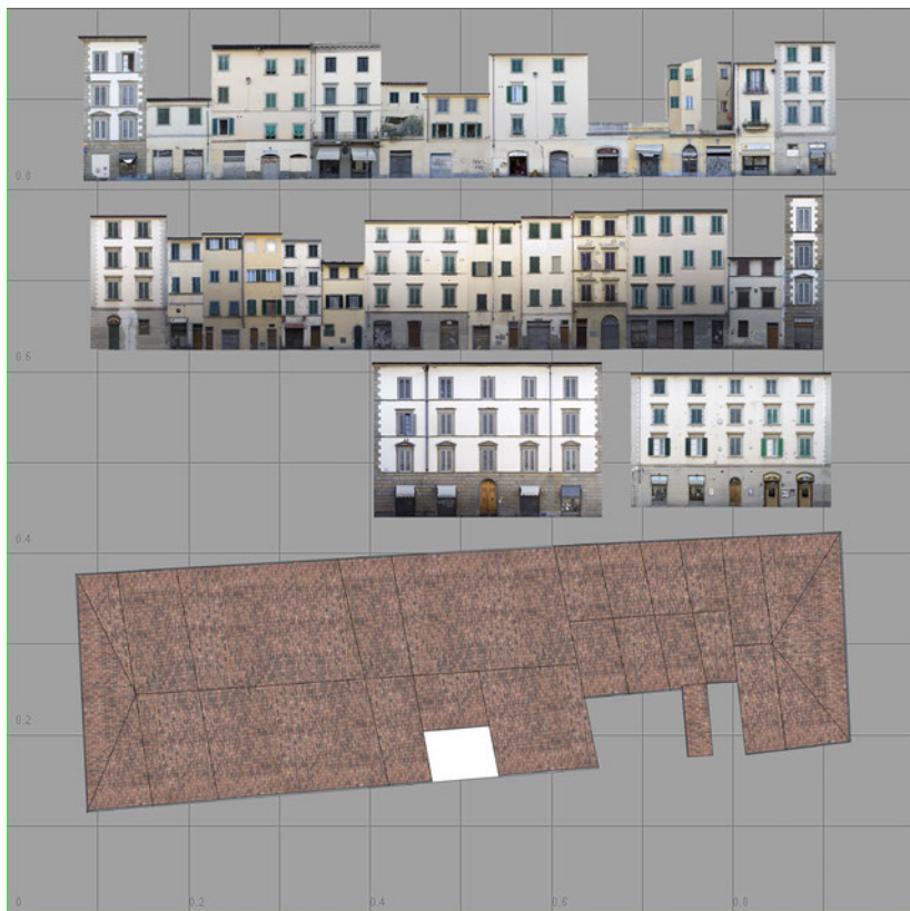
Fig. 9. Sviluppo nel sistema (u,v) dei fronti edilizi e delle coperture.
