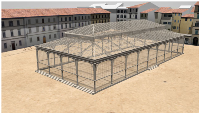
Fig. 7. Modellazione diretta del mercato di San Frediano, oggi non più esistente, sulla base dei disegni di progetto.
